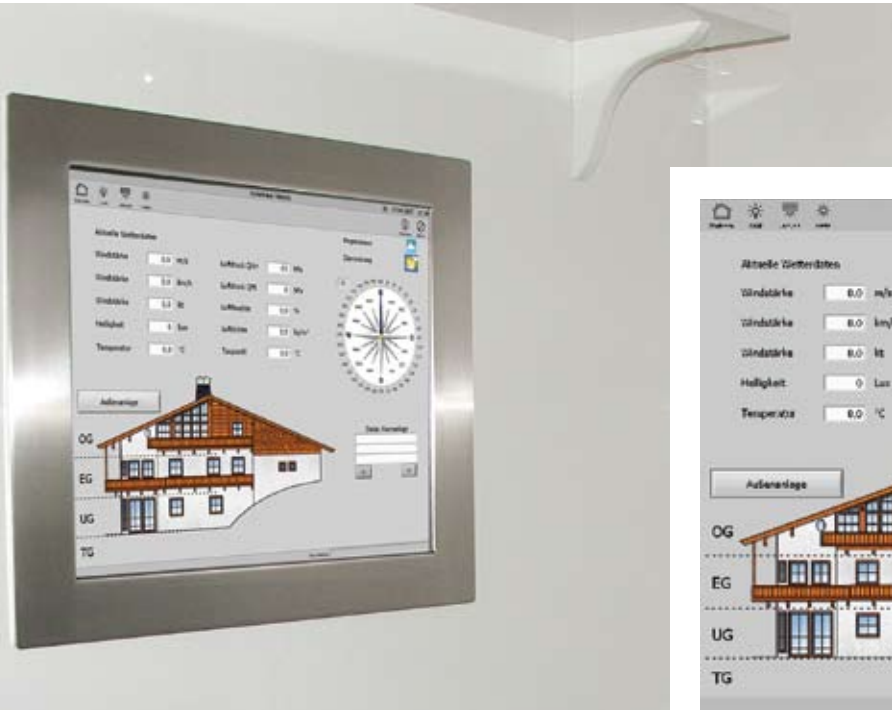
Der industrietaugliche Panel PC in Edelstahlausführung von tci ist robust, hygienisch und leicht zu reinigen. Deshalb ist er ideal für putzintensive Einsatzorte, wie die Küche, geeignet
